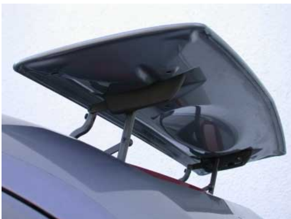
Ab einer Geschwindigkeit von 100 km/h erhöht ein automatisch ausfahrender Heckflügel den Anpressdruck auf die Hinterachse.
