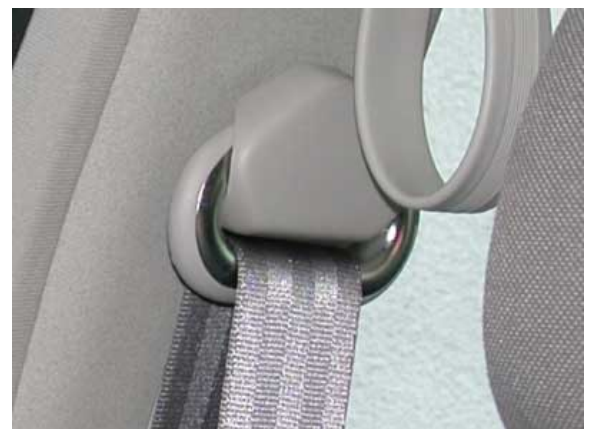
Harte, vorstehende Gurtbeschläge sollten heutzutage eigentlich nicht mehr vorkommen.
