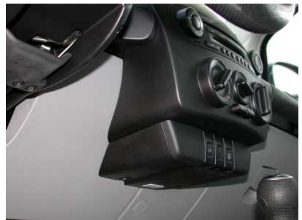
Die kantige Mittelkonsole erhöht bei einer Kollision das Verletzungsrisiko für die Knie.
