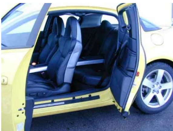
Revolutionär ist das Türsystem mit den hinten angeschlagenen Fondtüren. Noch nie konnte man die hinteren Sitze in einem Coupe so bequem erreichen wie hier.
