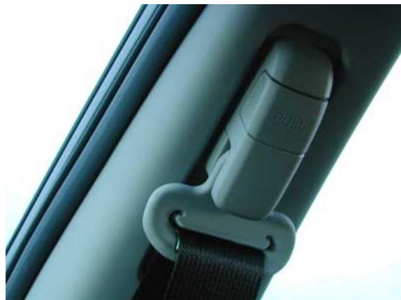
Vorstehende Gurtbeschläge erhöhen die Verletzungsgefahr bei einem Seitencrash.
