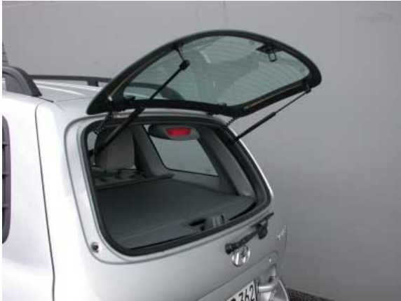
Durch die separat zu öffnende Heckscheibe ist das Beladen in engen Parklücken erleichtert.
