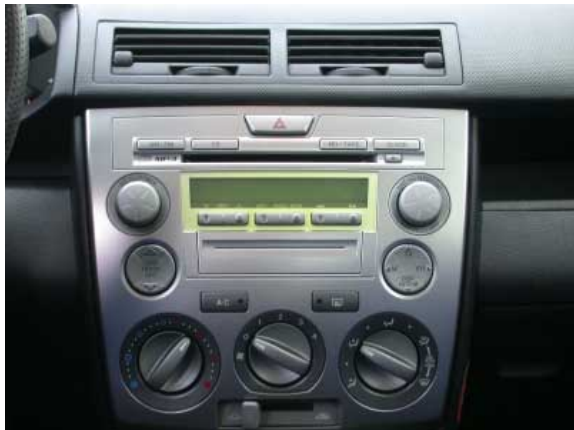
Die Kennzeichnung der Bedienelemente an der Mittelkonsole ist z.T. schlecht erkennbar. Hier könnte man ohne großen Aufwand eine Verbesserung erzielen.
