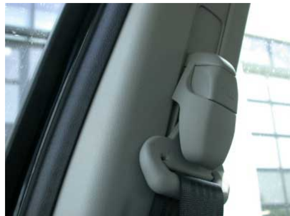
Hervorstehende Gurtbeschläge bedeuten ein erhöhtes Verletzungsrisiko bei einem Seitenaufprall.
