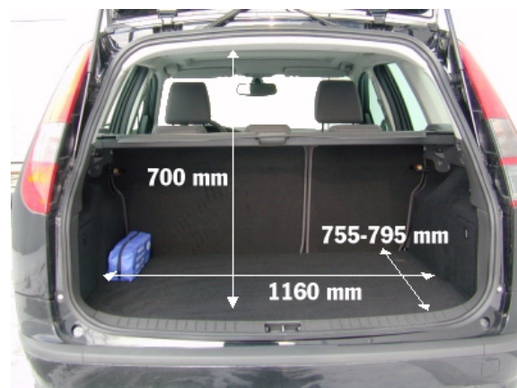
Mit 465 l Kofferraum-Volumen übertrifft der neue Focus Turnier den Opel Astra Caravan mit 450 l, bleibt aber deutlich kleiner als die der französischen Konkurrenten Peugeot 307 Break mit 495 l bzw. Renault Megane Grandtour mit 505 l Volumen.
