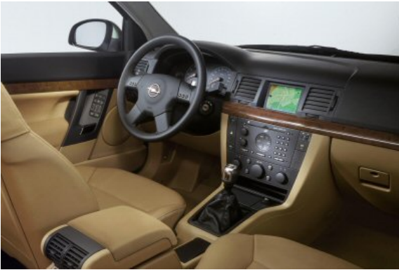
Während die Instrumente und das Display in der Mittelkonsole sehr gut im Blickfeld liegen, sind die Bedienelemente für Heizung und Lüftung wegen der geringen Größe und der tiefen Lage leicht zu verwechseln.
