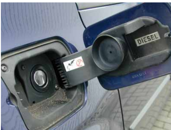
Eine einfache, aber sinnvolle Lösung ist der in die Klappe integrierte Tankdeckel.
