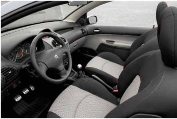
Die Regler für Heizung und Lüftung sind wie bei vielen Fahrzeugen zu tief, außerhalb des Sichtbereichs, angebracht.
