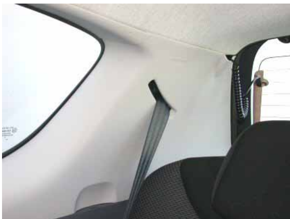
Die breiten C-Säulen behindern die Sicht nach schräg hinten.
