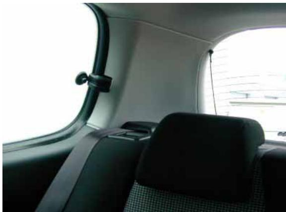
Trotz der relativ breiten C-Säulen ist die Sicht nach hinten aufgrund der fast vollständig versenkbaren Kopfstützen befriedigend.
