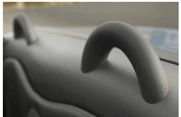
Überrollbügel sollen die Insassen bei einem Überschlag schützen.
