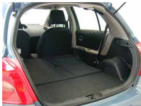
Mit 225 l Volumen ist der Kofferraum des Yaris um 25 l größer als noch beim Vorgänger. Klappt man die Rücksitze nach vorne, stehen 640 l zur Verfügung.
