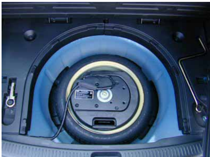
Lediglich ein schmales Notrad steht bei einer Reifenpanne als Ersatz zur Verfügung.
