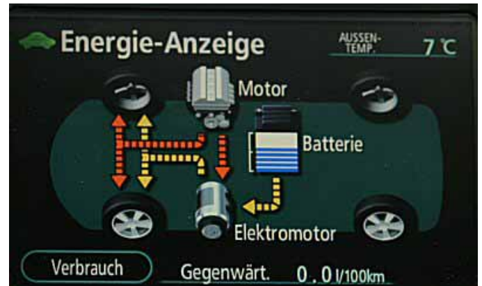
Auf dem Farbmonitor kann man den Betriebszustand des Hybridsystems jederzeit kontrollieren.
