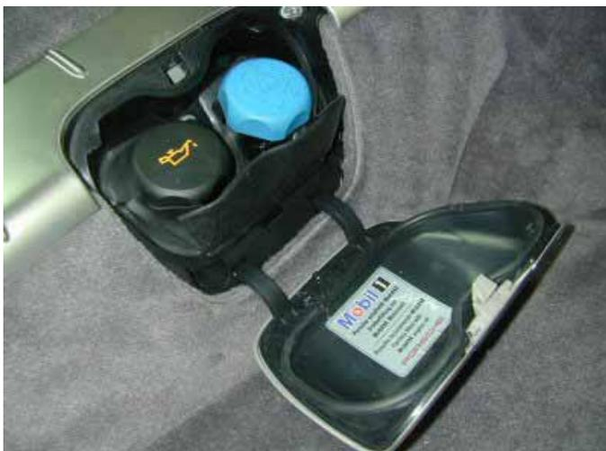
Eine Wartungsklappe im hinteren Kofferraum verbirgt die Einfüll- stutzen für Motoröl und Wasser. Hier heißt es gut zielen, um Ver- schmutzungen des Teppichs zu vermeiden.
