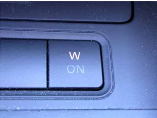
Mit dieser unscheinbaren Taste wird der Wintermodus aktiviert, der das Drehmoment des bärenstarken Motors in den unteren Gängen zügelt.
