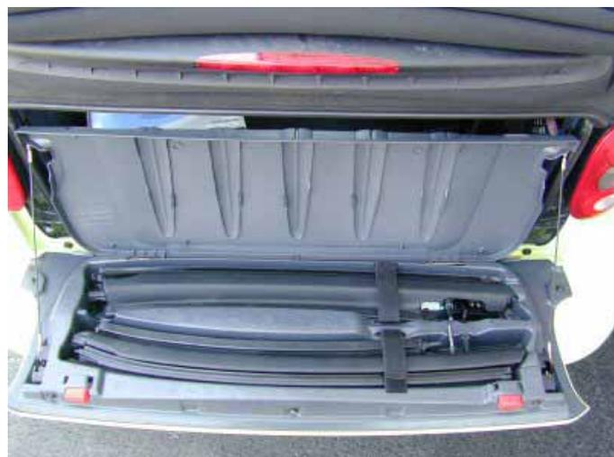
Die demontierten Dachholme lassen sich praktisch in der Heckklappe verstauen
