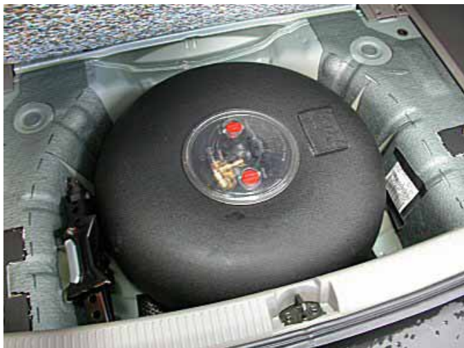
Der 53 l fassende Flüssiggastank befindet sich in der Reserveradmulde und schränkt damit den Nutzwert des Kofferraums nicht ein.
