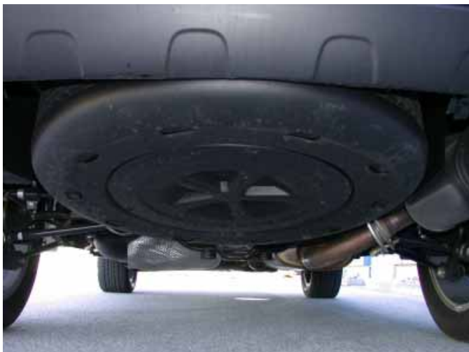
Das Reserverad ist außen unter dem Kofferraumboden befestigt. Das spart Platz im Innenraum.
