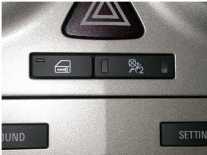
Die Airbags des Beifahrersitzplatzes lassen sich per Druckschalter am Armaturenbrett deaktivieren. Damit können auch auf diesem Sitzplatz rückwärtsgerichtete Kindersitze verwendet werden.
