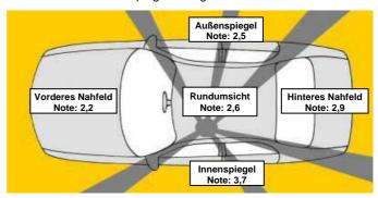
Die Rundumsicht-Note informiert, wie stark die Fensterpfosten und Kopfstützen die Sicht des Fahrers einschränken. Bei den Innen- und Außenspiegeln werden deren Sichtfelder aus dem Blickwinkel des Fahrers bewertet. Die Noten des vorderen und hinteren Nahfeldes zeigen, wie gut der Fahrer Hindernisse unmittelbar vor bzw. hinter dem Fahrzeug erkennt.
