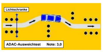
Beim ADAC-Ausweichtest erfolgt die Einfahrt in die Pylonengasse mit einer Geschwindigkeit von 90 km/h bei mindestens 2000 Motorumdrehungen im entsprechenden Gang. Geprüft wird die Fahrzeugreaktion, d.h. die Beherrschbarkeit beim anschließenden Ausweichen.
