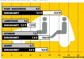
Kraftstoffverbrauch in I/100 km - Klassendurchschnitt für Fahrzeuge mit Dieselmotor (D) und Fahrzeuge mit Ottomotor (B).
