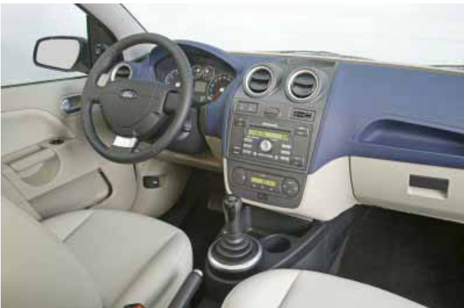
Leider heute ein weit verbreitetes Manko vieler Fahrzeuge - die viel zu tief angeordneten Bedienelemente für Heizung und Lüftung.
