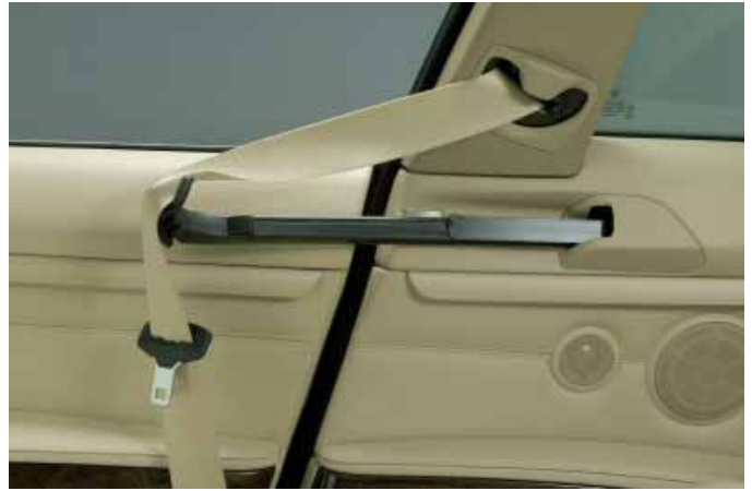
Wie bei Mercedes wird der Gurt zum leichteren Anlegen elektrisch nach vorne geführt.
