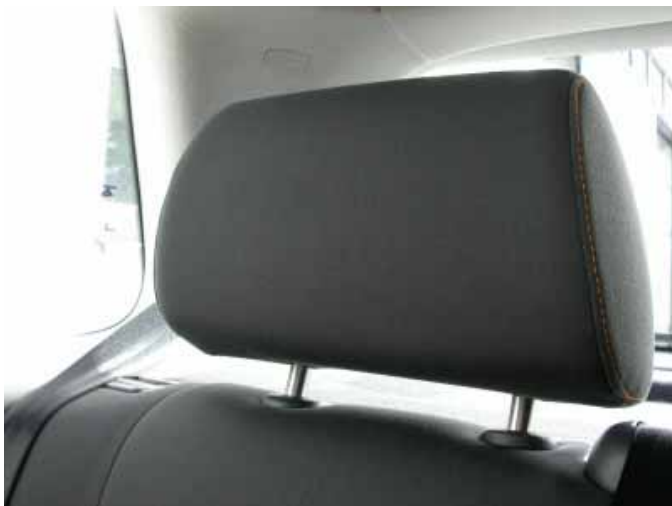
Die hinteren Kopfstützen besitzen keine feste Arretierung und schränken die Sicht nach hinten stark ein.
