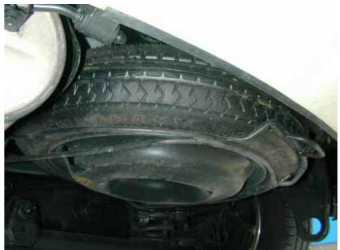
Nur ein schmales Notrad steht bei einer Reifenpanne für die Fahrt in die nächste Werkstatt zur Verfügung. Schlimmer ist jedoch die Tatsache, dass das defekte, verschmutzte Rad nicht in die Reserveradaufnahme passt und somit im Fahrzeug mitgeführt werden muss.
