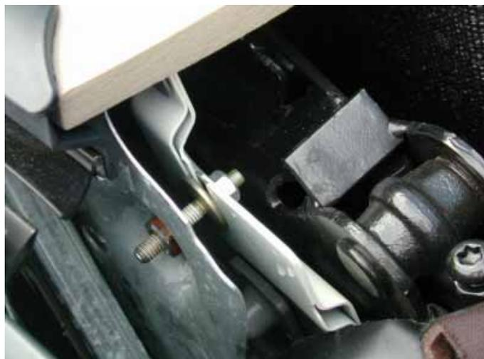
Ist das Dach geöffnet, fällt der Blick auf die nicht abgedeckte blanke Verdeckmechanik.
