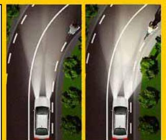
an Bord (Aufpreis). Bi-Xenonscheinwerfer, die die Fahrbahn ausgezeichnet ausleuchten, sind ebenfalls optional erhältlich; dynamisches Kurvenlicht kann zusätzlich bestellt werden. Die Rückspiegel blenden selbsttätig ab (innen Serie, außen Aufpreis).
