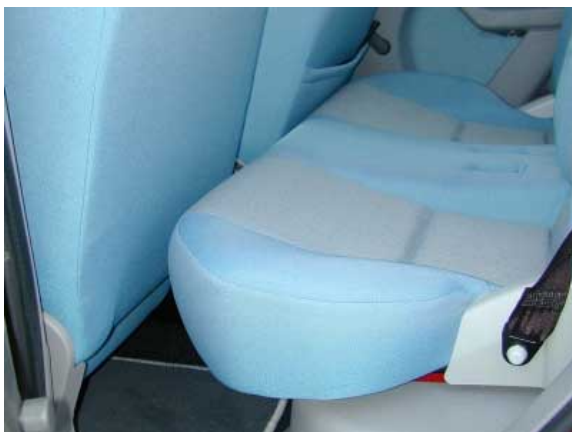
Um das Kofferraumvolumen zu vergrößern, lässt sich die gesamte Rücksitzbank nach vorne schieben. Dann bleibt jedoch kein Knieraum für die hinten Sitzenden erhalten.
