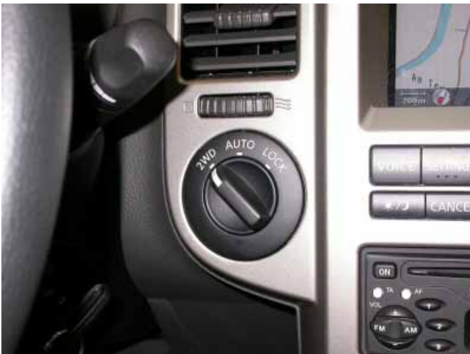
Der Schalter zum Wählen der Antriebsart befindet sich griffgünstig rechts neben dem Lenkrad.
