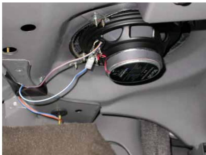
Die Verarbeitung der Audioanlage reicht nicht über das Niveau einer Bastellösung hinaus.
