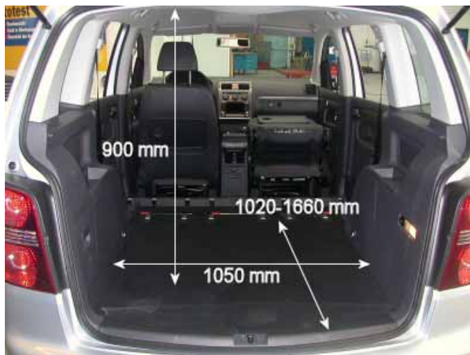
Mit 475 l Volumen ist der Kofferraum des Touran um 20 l kleiner als beim Konkurrenten Opel Zafira.
