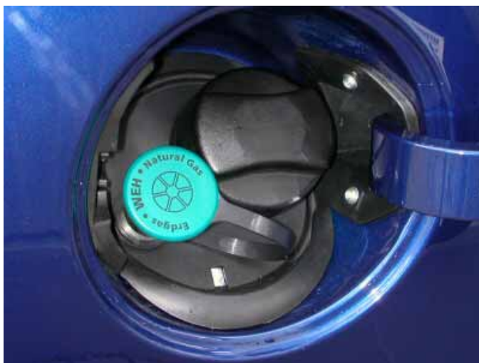
Der Einfüllstutzen für den Gastank ist unter der Tankklappe positioniert.
