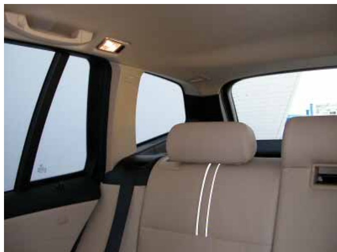
Lediglich die hinteren Dachpfosten behindern die ansonsten gute Übersichtlichkeit im X3.
