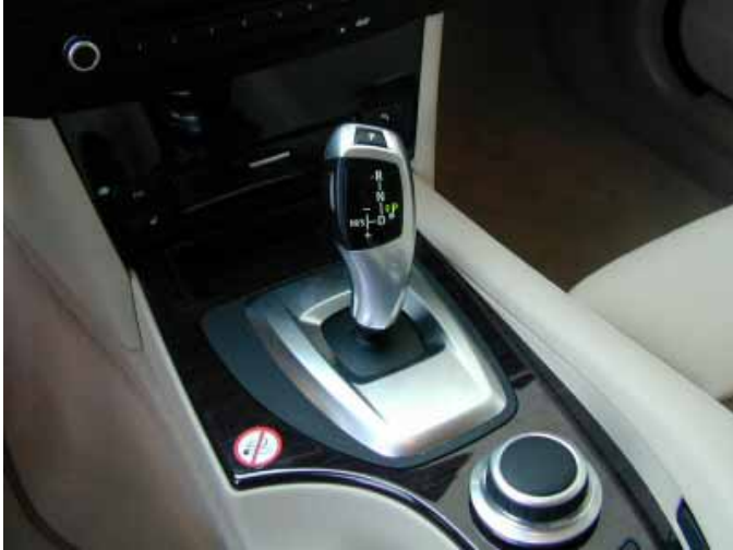
Der Automatik-Wählhebel besitzt jetzt eine Joystick-Form und eine wenig intuitive Schaltlogik.
