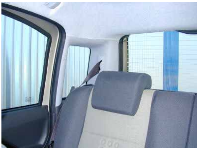
Die Kopfstützen der Rücksitzbank lassen sich weitgehend versenken und behindern damit die Sicht nur wenig.
