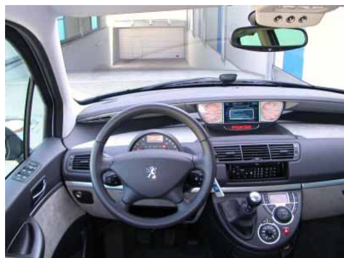
Kritikpunkt sind die in der Mitte des Armaturenbretts angeordneten, schlecht ablesbaren Instrumente.
