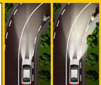
zusätzlich ist dazu adaptives Kurvenlicht erhältlich. Diese Kombination sorgt für optimale Straßenausleuchtung bei Nachtfahrten. Eine weitere sinnvolle Option sind die automatisch zu- und abschaltenden Fernscheinwerfer.
