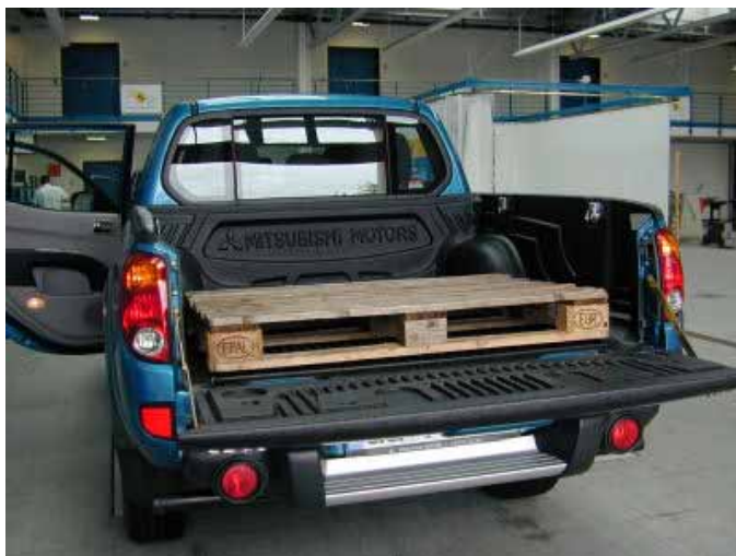
Die Ladefläche ist großzügig und bietet Platz für eine Euro-Palette. Die hohe Lage der Ladefläche erschwert allerdings die Beladung.
