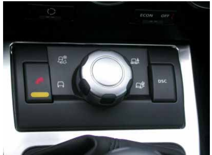
Das patentierte Terrain Response System stimmt den Freelander per Drehknopf optimal auf die jeweiligen Fahrbahnbedingungen ab.
