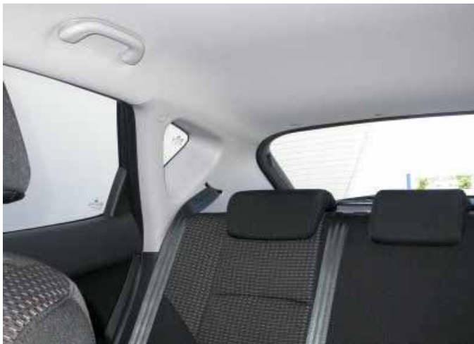
Die versenkbaren Kopfstützen verbessern die Sicht nach hinten, die breiten C-Säulen beeinträchtigen aber den Blick nach schräg hinten sehr.
