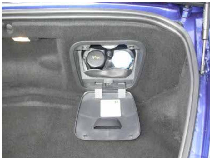
Eine Wartungsklappe im hinteren Kofferraum verbirgt die Einfüllstutzen für Motoröl und Wasser. Um Verschmutzungen des Teppichs zu vermeiden sollte man gut zielen können.
