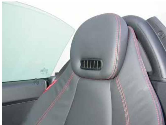
Das aufpreispflichtige Airscarf-System mit den in den Kopfstützen integrierten Austrittsöffnungen für Warmluft macht den Cabriogenuss auch bei kälterem Wetter angenehm.
