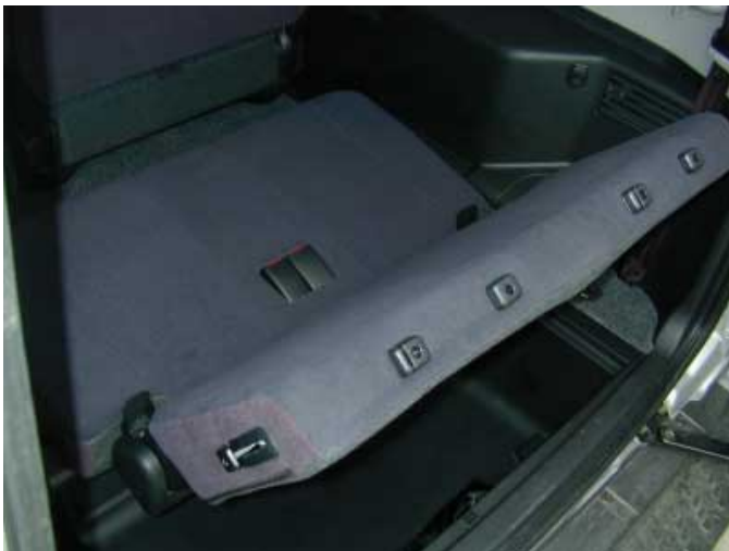
Die dritte Sitzreihe lässt sich komplett im Boden versenken.
