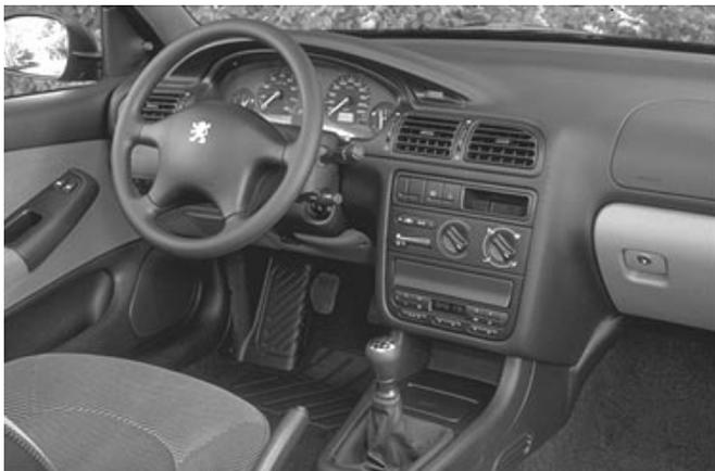
Ein funktionelles, übersichtliches Armaturenbrett mit intelligenten Detaillösungen: So kann die serienmäßige Audioanlage vom Lenkrad aus bedient werden.
