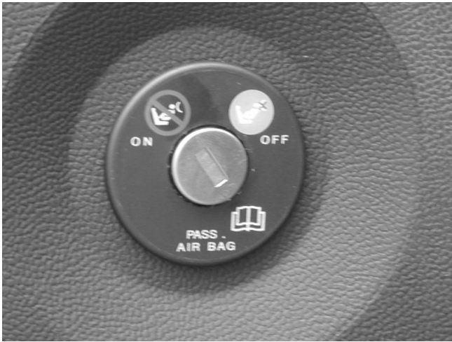
Sinnvoll ist die Möglichkeit zur Deaktivierung des Beifahrerairbags per Zündschlüssel. Somit können auch rückwärtsgerichtete Kindersitzsysteme auf dem Beifahrerplatz befestigt werden.
