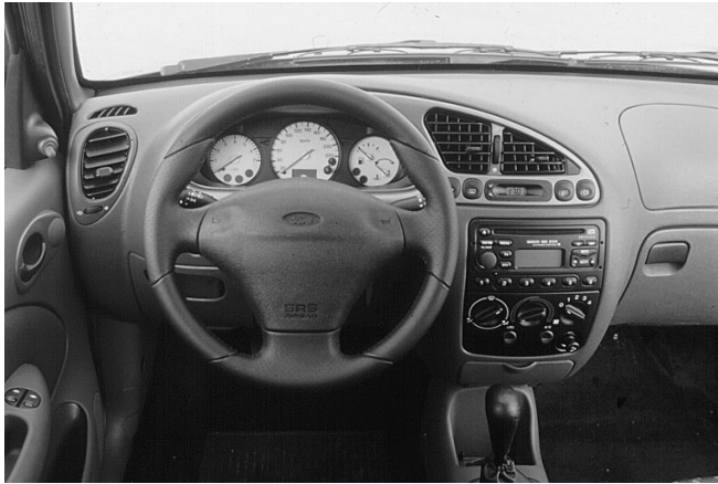
Das Armaturenbrett des Fiesta ist überwiegend funktionell. Ärgerlich ist jedoch die zu tiefe Anordnung der Heizungsbedienung und das Fehlen einer Kontrollleuchte für das Abblendlicht bzw. Intervallschaltung für den Heckwischer
