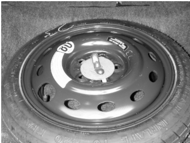
Das schmale Notrad ist nur für die Fahrt bis zur nächsten Werkstatt geeignet.
