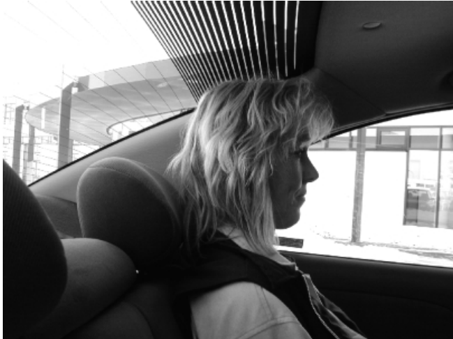
Viel zu niedrige Kopfstützen und eine schlechte Gurtgeometrie kennzeichnen die hinteren Sitzplätze
