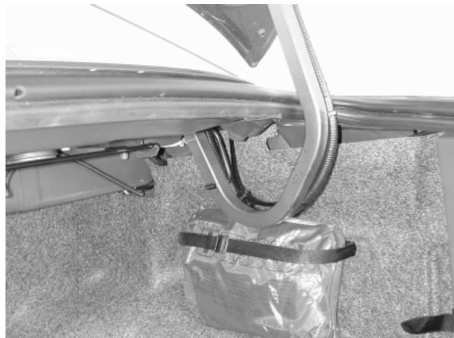
Die Haltebügel der Kofferraumklappe können das Gepäck beschädigen
