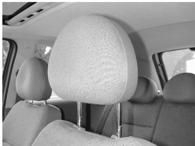
Jetzt auch im Corsa: Die "aktiven Kopfstützen", welche bei einem Heckaufprall selbsttätig den Abstand zum Kopf verringern.
